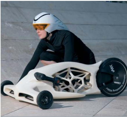
Das weltweit erste in einem Stück gedruckte 3D-Fahrzeug, neun Kilo schwer, von einem Akkuschrauber angetrieben
