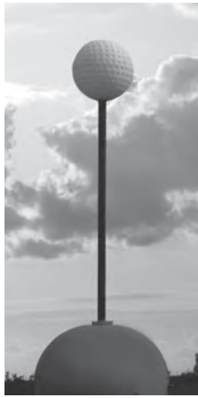
Prototyp des neuen Kugelanemometers für Windgeschwindigkeits- und Windrichtungsmessungen
