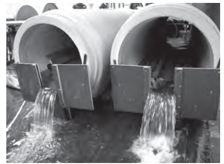
Verstellbares Schütz zur Simulation unterschiedlicher Betriebszustände im Kanal
