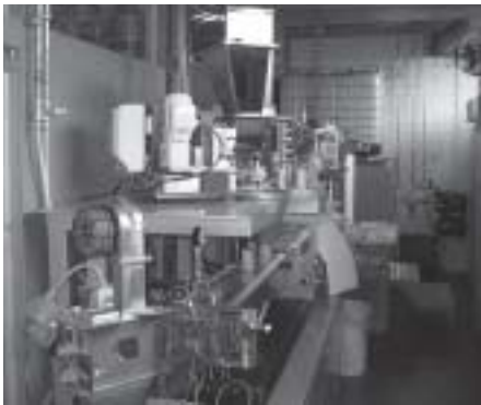
Extrusionsanlage mit Dosiereinheiten und Heizabschlag zur Aufbereitung im Labormaßstab
