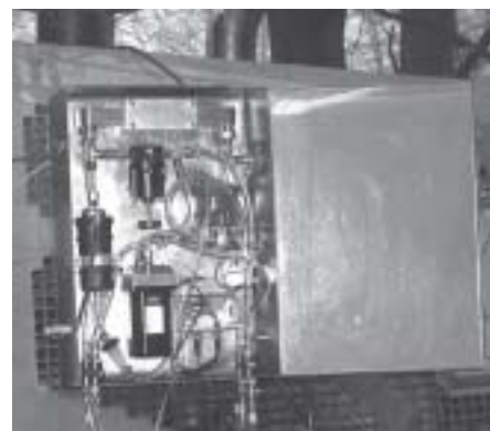
Treibstoffverbrauchsmessungen am Harvester
