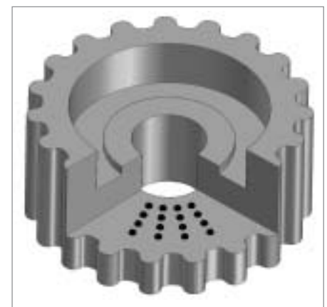
Prinzipalskizze einer Zahnriemenscheibe mit eingebrachten Fremdpartikeln als Informationsspeicher
