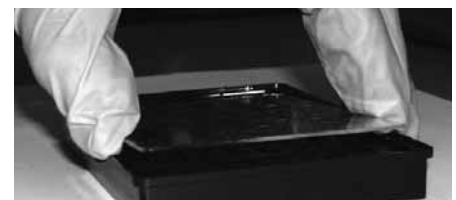
Bei der modifizierten 96-Well-Platte (mcp) kann der Boden mit den Zellproben abgenommen und weiter untersucht werden.
