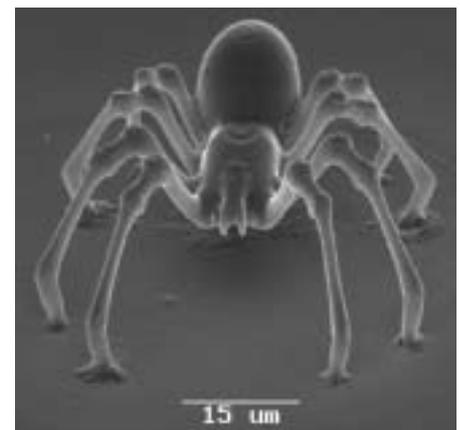
Mikrostruktur in Form einer Spinne: Der 2-Photonen-Laser härtet Polymere in einer Spezialflüssigkeit aus, die überschüssige Lösung wird abgewaschen.
